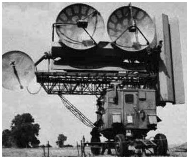
Приёмно-передающая кабина комплекса ПВО С-75, конструкция которой разработана Г.В. Кисунько, с антенно-фидерными трактами для определения угла места, азимутального угла цели, управления ракетой В-875 и подачи команд на подрыв её боевого заряда
