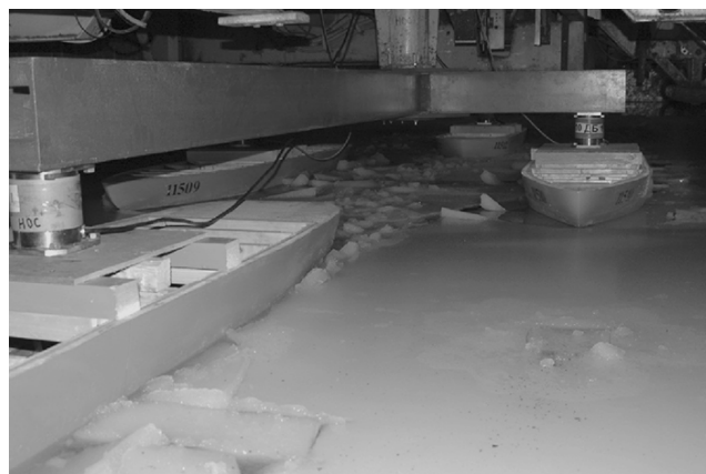
Рис. 1. Модельные испытания нового многокорпусного ледокола в ровных льдах
