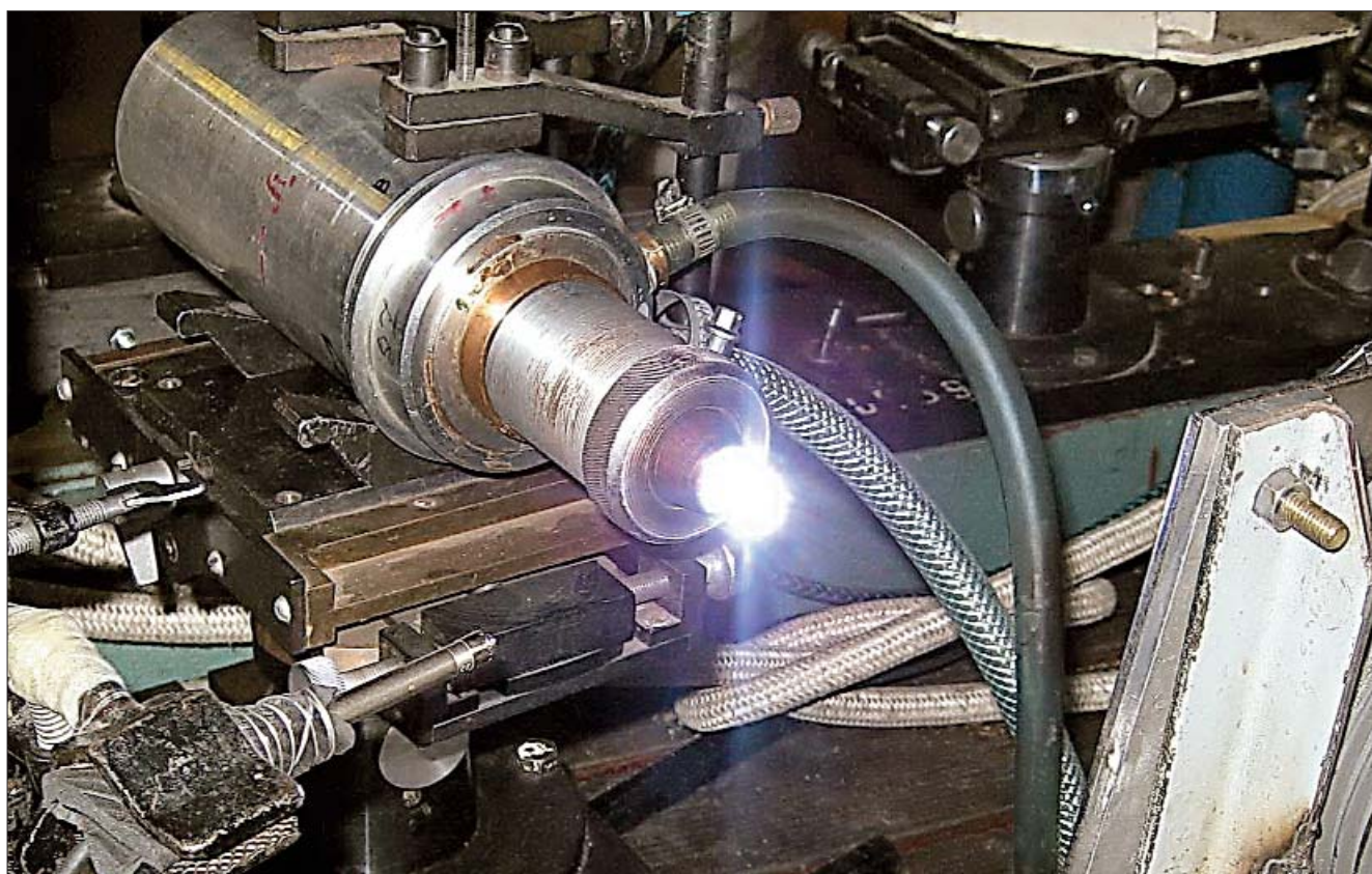
Измерение характеристик ударных волн в лазерной плазме сверхзвукового потока газа.
