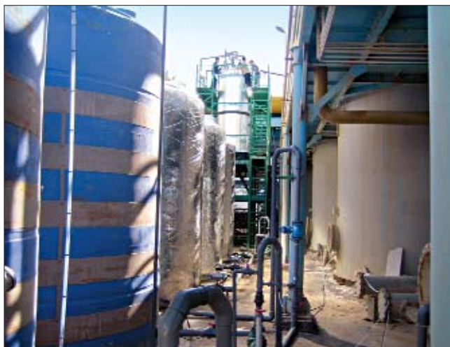
Сорбционно-десорбционный модуль для получения литиевого концентрата из рассола.
