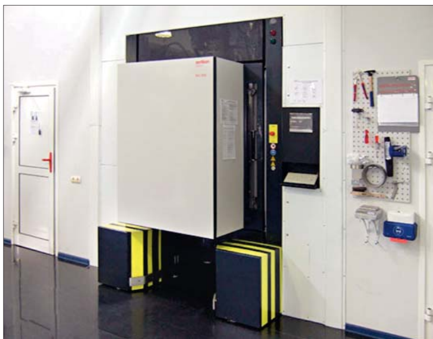
Установка для нанесения покрытия. Через эту дверь загружается «карусель» с инструментом.
