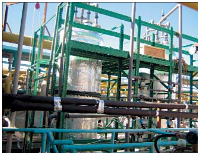
Сорбционно-десорбционный модуль для получения литиевого концентрата из рассола.
