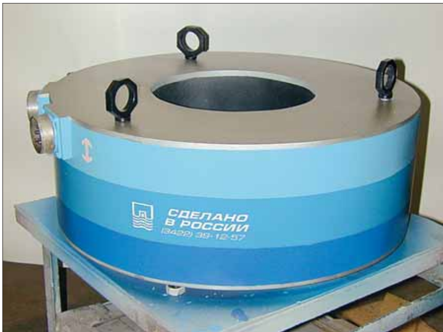
МГД-перемешиватель для производства цилиндрических полунепрерывных слитков из алюминия и его сплавов и производства композитных материалов на основе алюминия. Устройство осуществляет отдельно регулируемое перемешивание металла в двух плоскостях.
