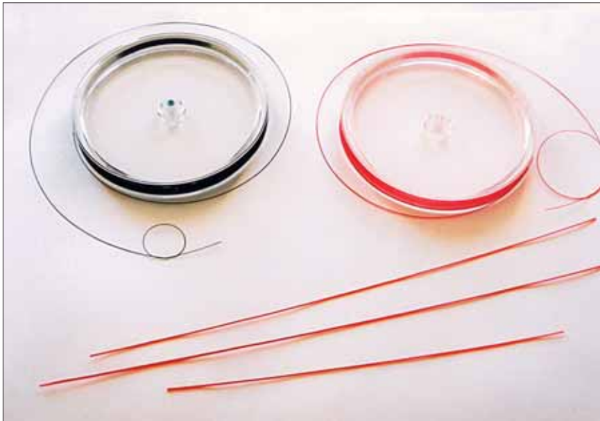
Халькогенидные световоды из селенида мышьяка (слева) и сульфида мышьяка.
