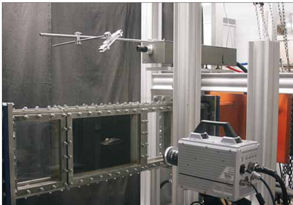
Высокоскоростной программно-алгоритмический комплекс цифровой трассерной визуализации для исследования кавитационных течений.
