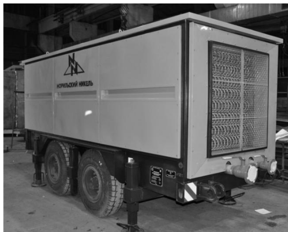
Рисунок. Система кондиционирования воздуха рудника «Таймырский» ГМК «Норильский никель»
