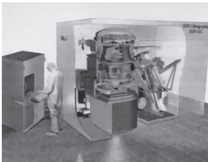
Рис. 2. Первый литограф для диапазона 13 нм, построенный в США
