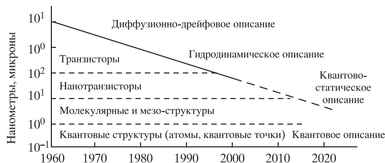
Рис. 1. Экспоненциальное уменьшение размеров приборов микроэлектроники приводит к элементам нанометрового размера, подчиняющимся законам квантовой механики
