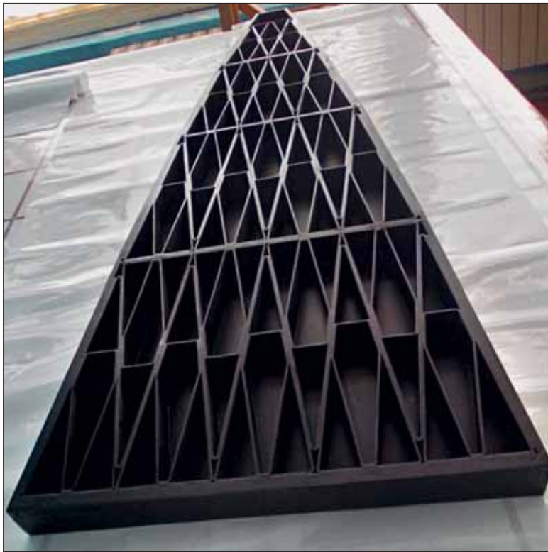
Макет прецизионной параболической панели зеркала-рефлектора для телескопа «Миллиметрон».
