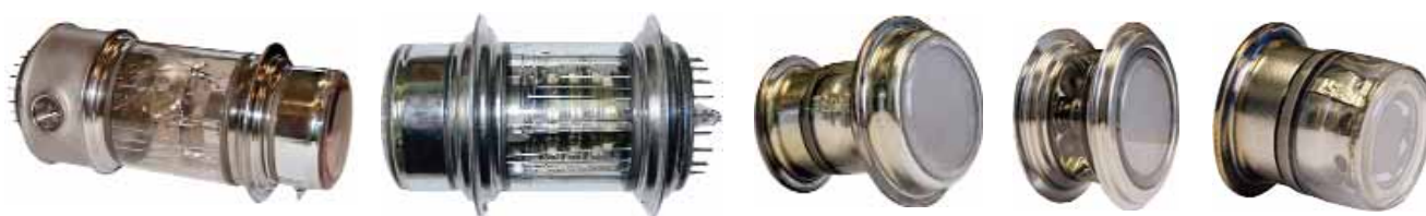
Фотоэлектронные умножители и фотоэлементы, созданные в НИИ импульсной техники: СНФТ20, СНФТ5, СДФ15М, СДФ20, СДФ21.
