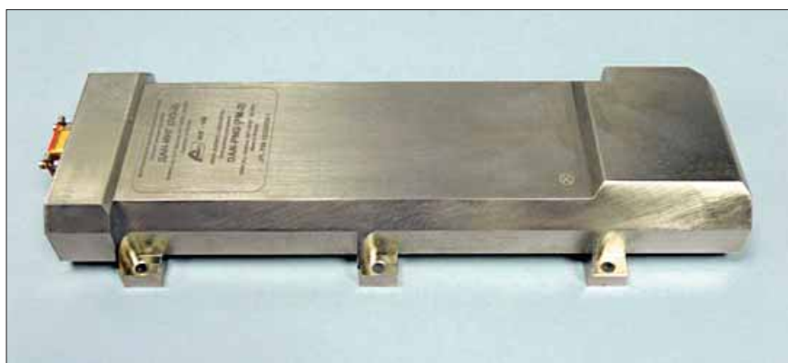
Летный образец детектора нейтронов, созданного в Институте космических исследований РАН.
