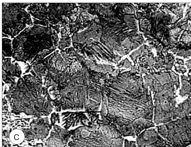
Структура образцов кричной (сырцовой) стали: А – стропила крыльца, участок с 0,7%-ным содержанием углерода (увеличение в 50 раз); В – ферритная сетка на краю полосы (увеличение в 50 раз); С – полосовая сталь арматуры крыльца с 0,5-0,6%-ным содержанием углерода (увеличение в 75 раз).
