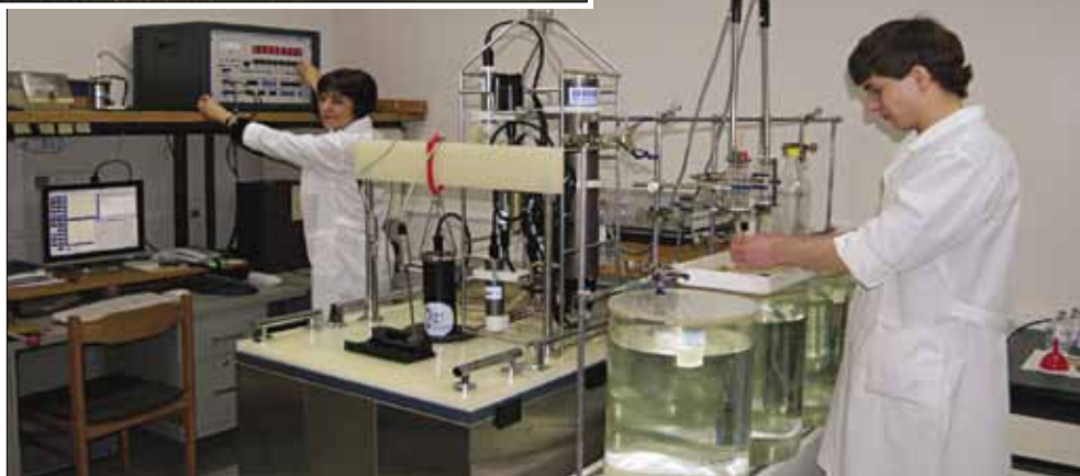
Комплекс калибровки СТД-зондов, предназначенных для измерения солености, гидростатического давления, температуры среды и других показателей.
