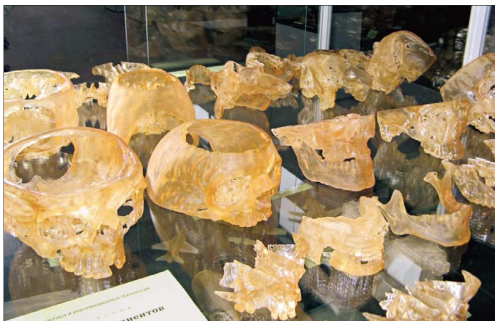
Образцы пластиковых стереолитографических моделей, выполненных по данным томографических исследований на установке ЛС-250 Института проблем лазерных и информационных технологий РАН.
