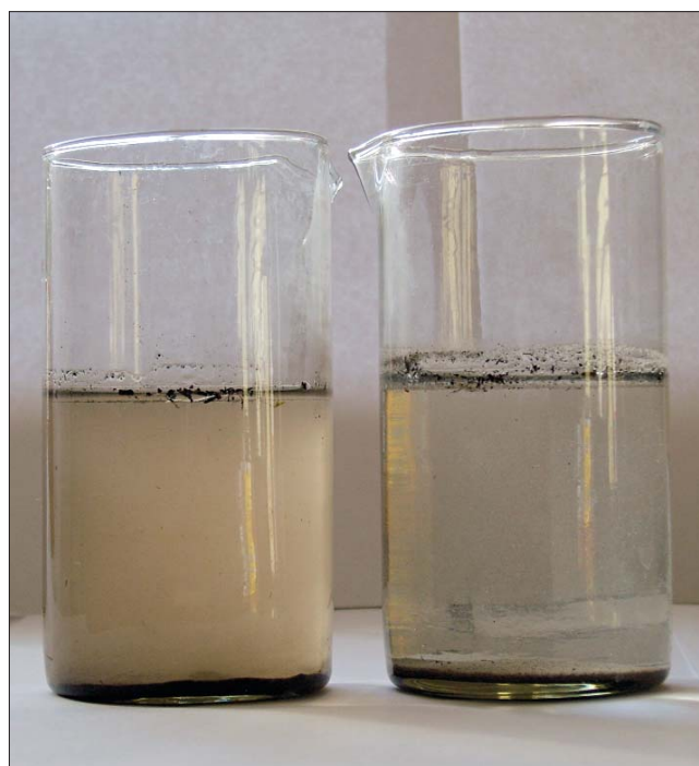
Титановый коагулянт очищает мутные воды: слева – до контакта с реагентом, справа – после контакта.
