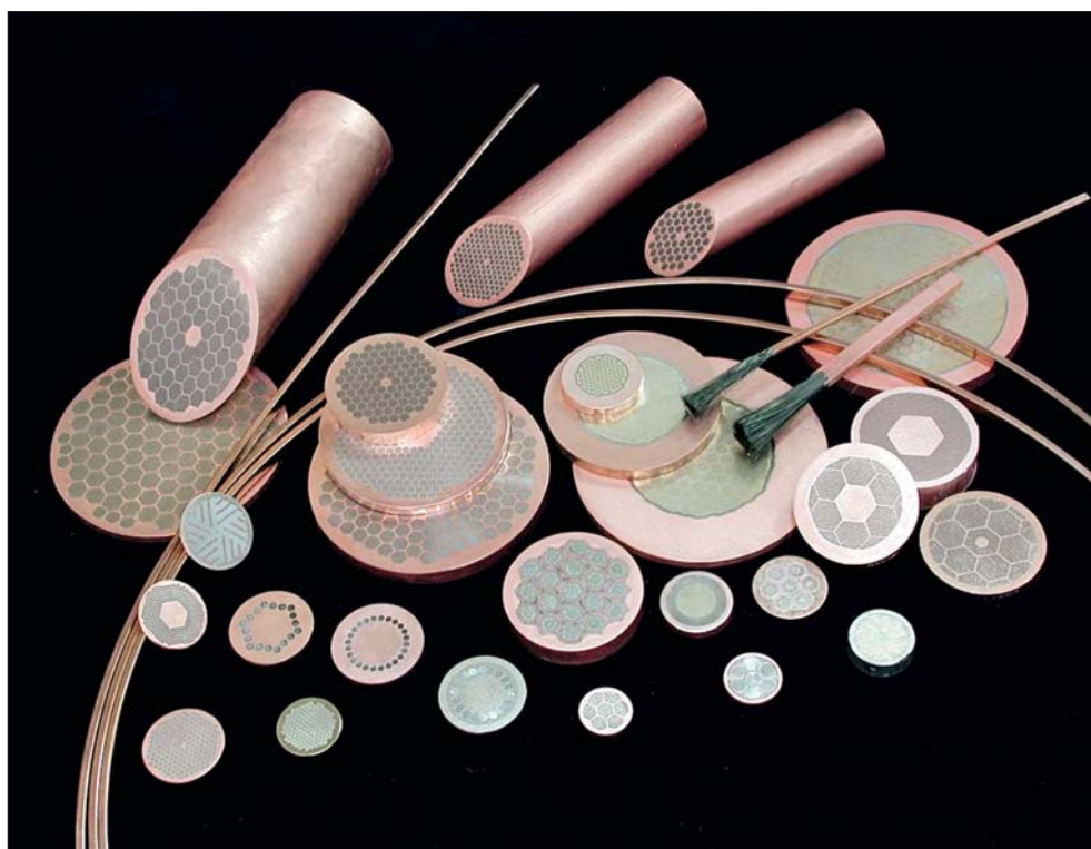
Сечения промышленных сверхпроводников.
