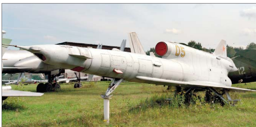
Ту-141 «Стриж» – многоцелевой беспилотный летательный аппарат для разведки на глубину несколько сотен километров от линии фронта на трансзвуковых скоростях с посадкой посредством парашютной системы, состоял на вооружении в 1979-1989 гг.
