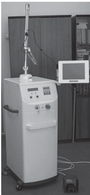
Рис. 4. Импульсно-периодический \text{CO}_2 -лазер для кожно-пластической хирургии и косметологии
