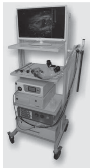
Рис. 5. Флуоресцентная видеосистема для повышения эффективности нейрохирургических операций с возможностью визуализации флуоресценции опухолевого процесса в режиме реального времени; в её составе: лазер, источник света, компьютер, двухканальный флуоресцентный адаптер
