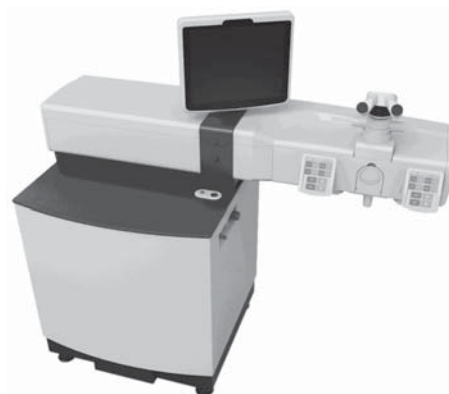
Рис. 1. Фемтосекундный лазер “Фемто Визум” для интрастромальной обработки роговицы
