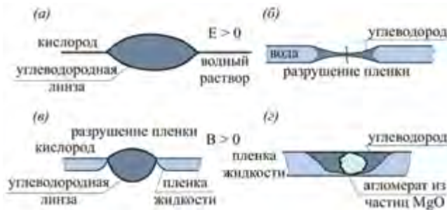
Рис. 1.3. (а) Выход углеводородной капли на межфазную поверхность; (б) схема распада жидкой пленки в пене по механизму «мостикообразование–растяжение»; (в) схема распада жидкой пленки в пене по механизму «мостикообразование–несмачиваемость»; (г) агломерат из оксида магния может способствовать разрушению пленки жидкости между пузырями [14].
