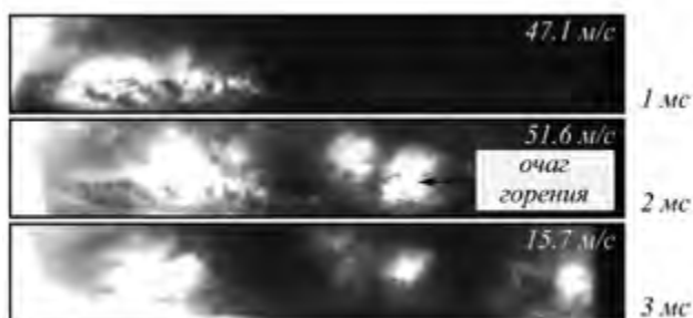
Рис. 4.3. Структура зоны горения при ускоренном режиме распространения пламени в пене на основе толуола в трубке диаметром 20 мм (кратность пены 8.6; общая скорость горения пены 38.2 м/с) [8].
