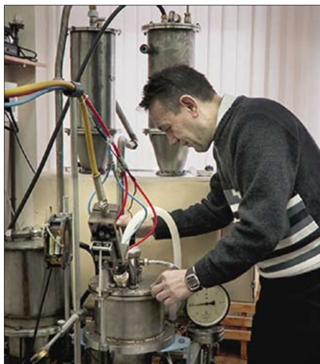
Установка для получения нанопорошков электровзрывом проволоочек.
