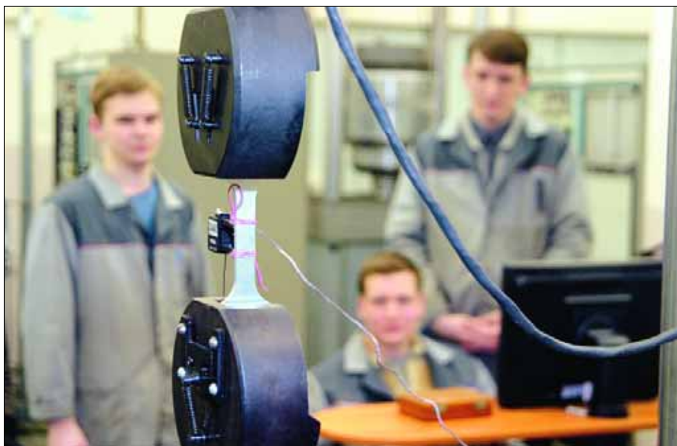
Испытания материалов с контролем уровня деформации в рабочей части образца.
