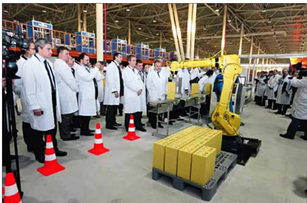
Готовые запаянные аккумуляторы весом от 10 до 26 кг поднимает робот-манипулятор.
