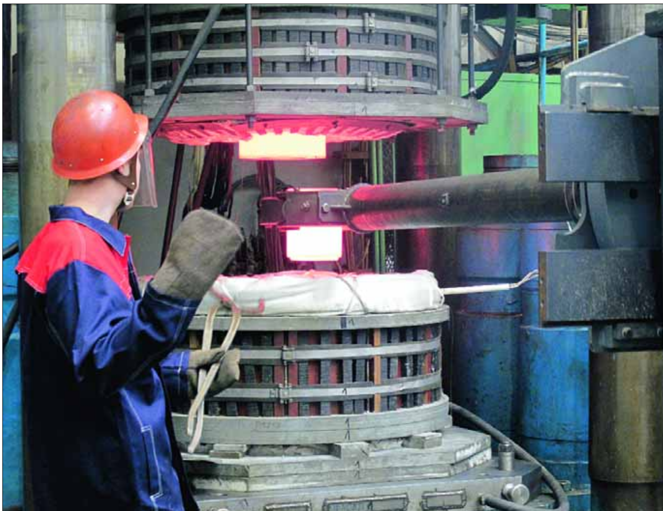
Производственный участок изотермической штамповки на воздухе, оснащенный специализированными прессами, где изготавливаются опытно-промышленные и серийные партии штамповок дисков.
