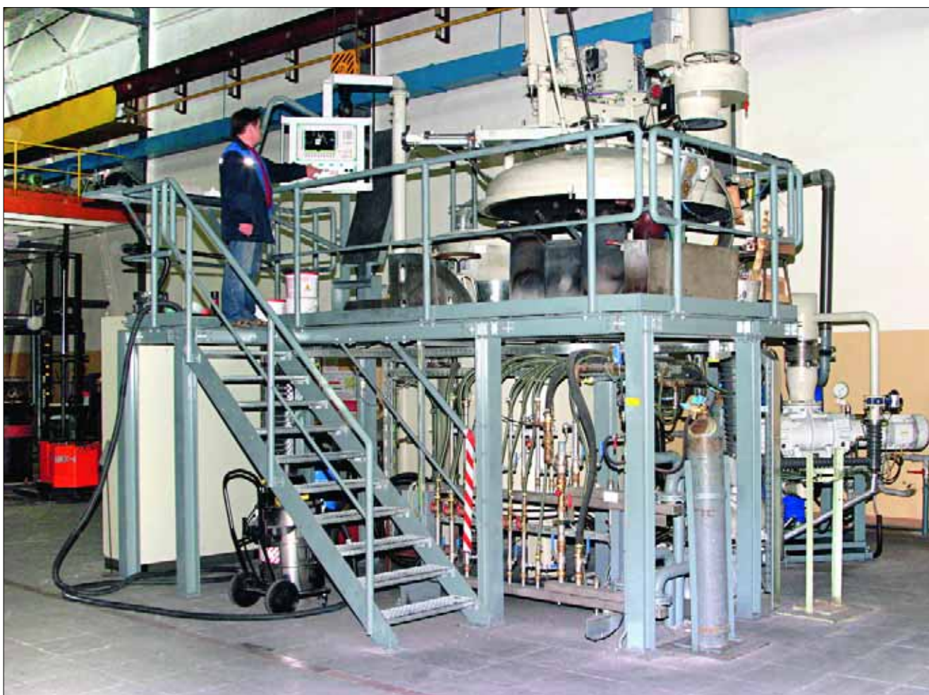
Вакуумная индукционная установка для выплавки литых прутковых заготовок из жаропрочных никелевых сплавов с высокой чистотой металла по примесям и узким интервалом легирования.
