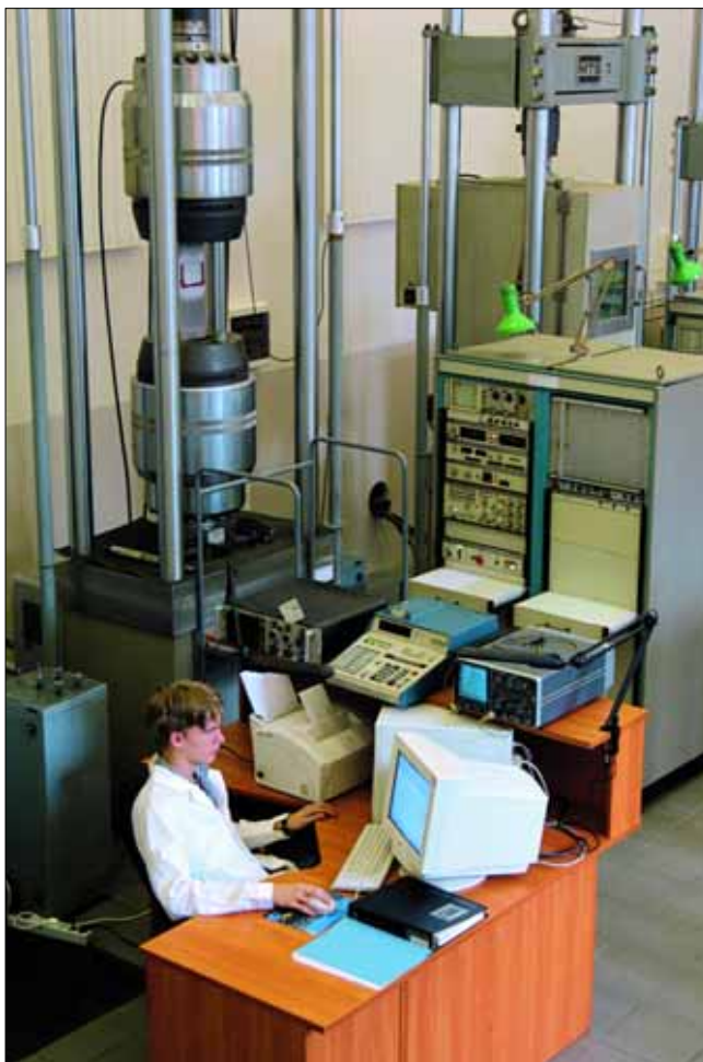
Проведение испытаний на трещиностойкость в условиях воздействия коррозионной среды на универсальной сервогидравлической машине.
