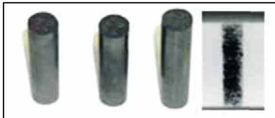
Топливные компакты с имитаторами топливных частиц
