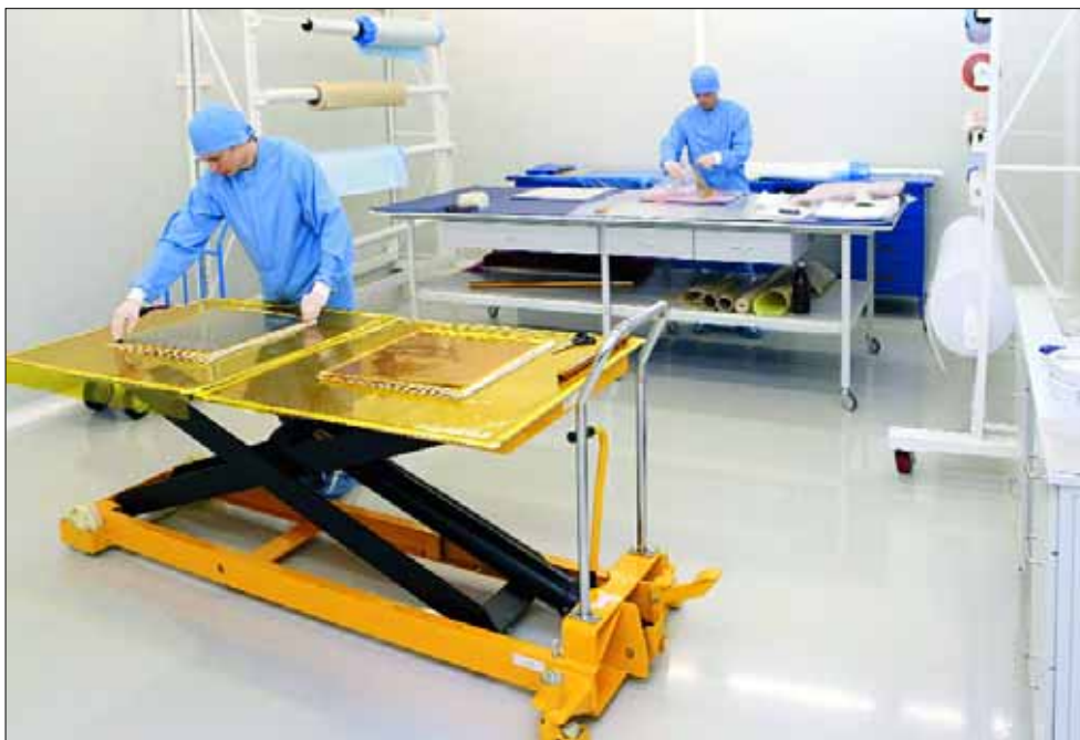
Сборка заготовок ПКМ в «чистой» комнате с контролируемым климатом и уровнем запыленности.
