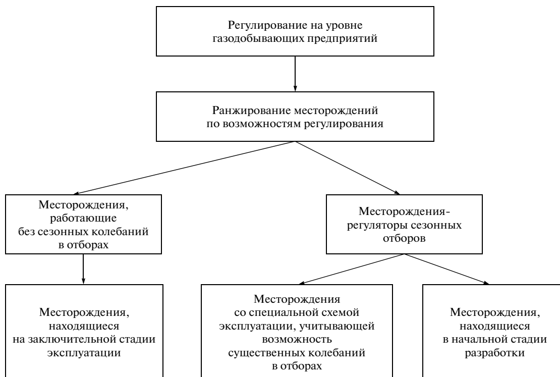
Рис. 3. Схема регулирования на уровне газодобывающих предприятий
