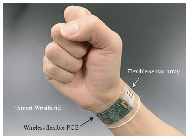
Устройство для анализа пота, позволяющее следить за физической нагрузкой спортсмена
