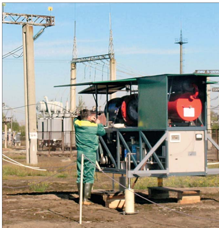
Мобильный комплекс на основе взрывомагнитных генераторов для испытания на молниестойкость энергетических объектов.
