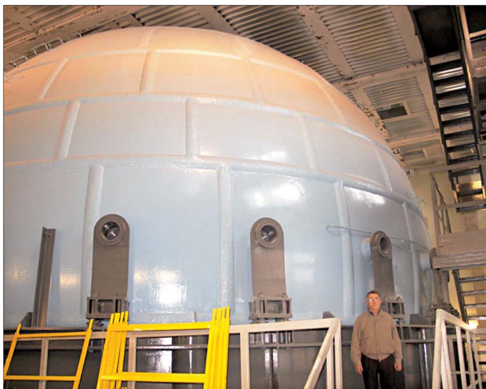
Уникальная сферическая взрывная камера 13ЯЗ (установка «Сфера» Московского регионального взрывного центра коллективного пользования РАН), изготовленная из броневой стали. Рассчитана на взрыв до 1000 кг тринитротолуола.
