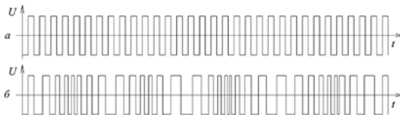
Рис. 3. Модель немодулированного сигнала (а) и модулированного сигнала крутильных колебаний (б) с первичного преобразователя
