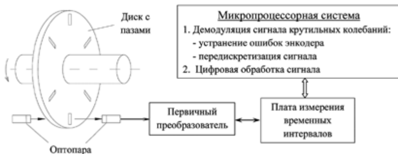
Рис. 2. Структурная схема измерения крутильных колебаний методом временных интервалов
