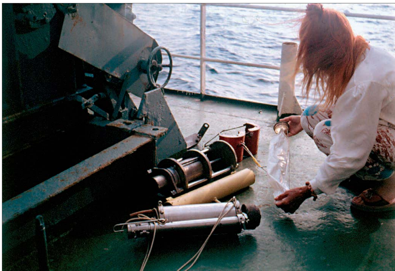
Пробоотборники требуют ухода – стерильной чистоты внутренней полости.
