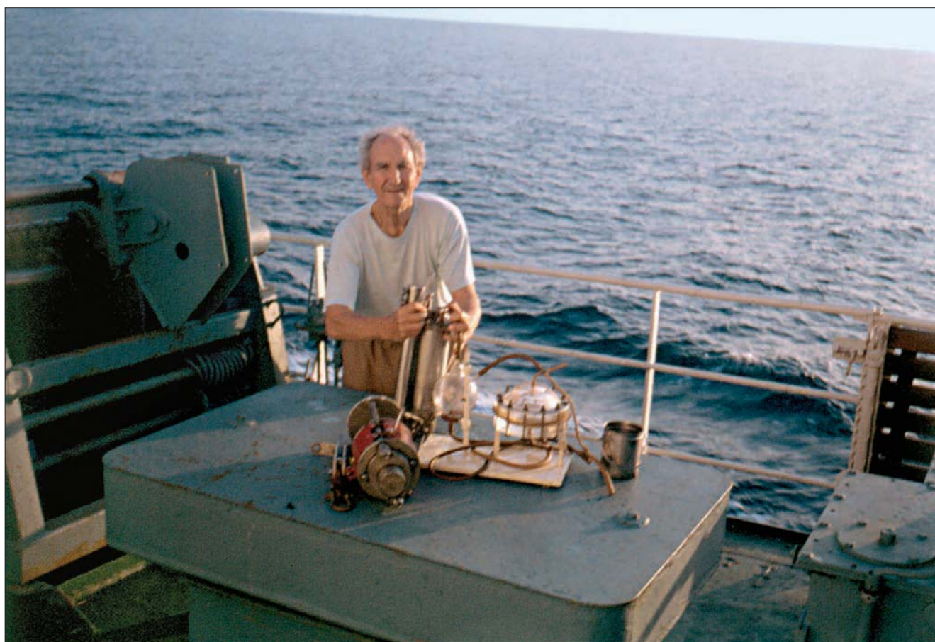
Операция по выделению газовой фазы из морской воды с помощью дегазационной установки.
