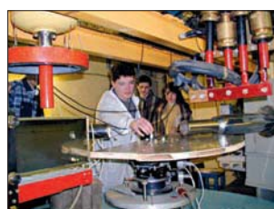
Экспериментальный зал реактора ИБР-2М имеет 14 каналов вывода нейтронов, на которых располагаются установки.
