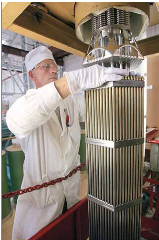
Выходной контроль готовых топливных сборок для атомных реакторов на Новосибирском заводе химических концентратов.
