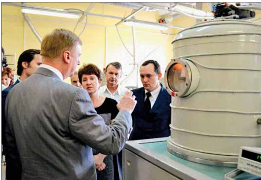
Один из важных этапов технологического производства датчиков – напыление полупроводникового материала в вакуумной установке.
