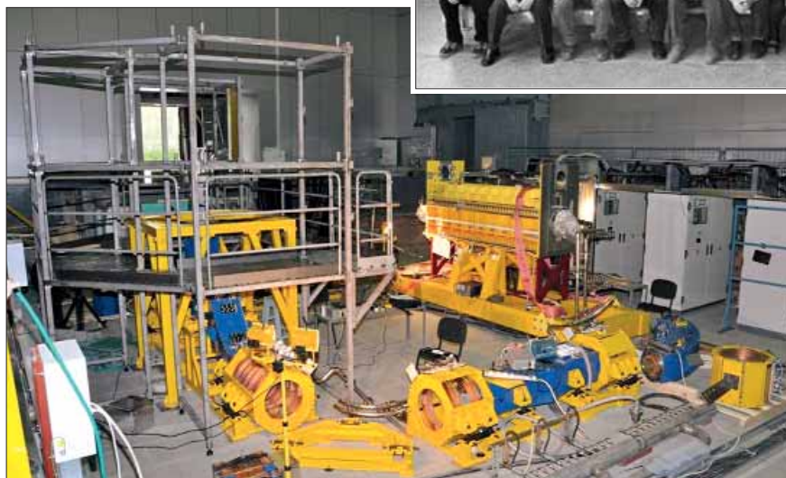
Установка электронного охлаждения протонных пучков для ускорителя COSY, разработанная в Институте ядерной физики им. Г.И. Будкера. Фото Центра общественных связей СО РАН
